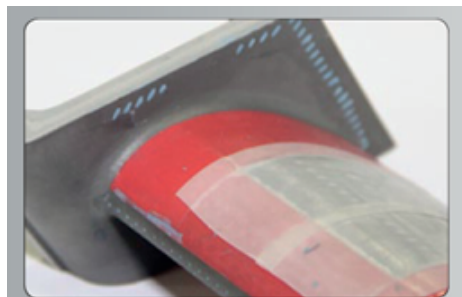
Многочисленные небольшие отверстия в этой турбинной лопатке могут быть быстро закрыты компаундом HVMC.
