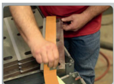
Нанесение ленты HVMT Orange на лопатку перед напылением GF-HVOF.
