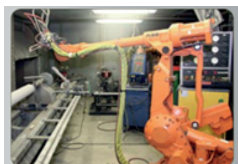
Роботы часто используются для термических напылений.
