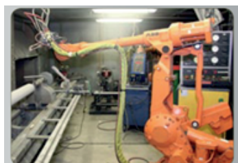
Роботы часто используются для термических напылений.
