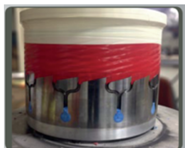
Защита лентой 170-10s Red и компаундом HVMC (голубого цвета) для закрытия отверстий.
