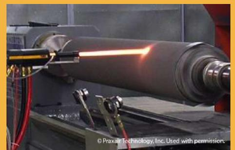
Обработка методом LF-HVOF вращающейся цилиндрической детали
